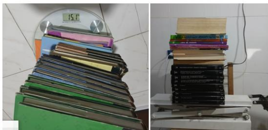
Figura 3. Ensayo experimental de carga para la estimación del torque necesario para ele-var 15,1 kg. Fuente: Alfaro, Epiayu, Mora & Barros (2025).
